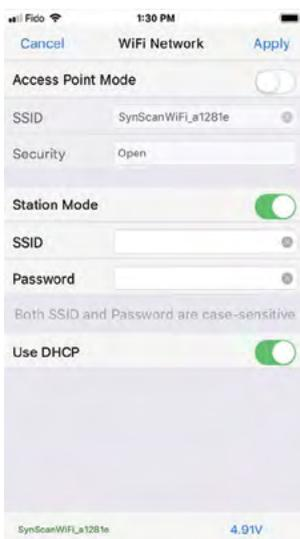
**Access Point (AP) Mode (Режим точки доступа):** режим, установленный по умолчанию. В этом режиме монтировка выступает в качестве точки доступа, и вы можете подключиться к ней при помощи приложения **Star Adventurer mini Console**.
