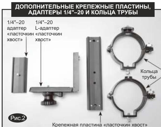
Если на трубе вашего телескопа уже есть крепежная пластина «ласточкин хвост», установить телескоп на монтировку крайне просто. Сначала открутите винты с рифленой головкой и маленькие винты фиксации на выбранном держателе пластины так, чтобы их края сравнялись с поверхностью внутренней стенки. Затем вставьте крепежную пластину телескопа в выбранный держатель и надежно затяните два винта фиксации.
