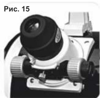
Установив фотооборудование в это положение, необходимо настроить натяжение фокусера с помощью большого винта, расположенного под фокусером, как показано на рисунке 17. Правильное натяжение позволяет вам плавно фокусироваться на объектах, при этом не дает фотооборудованию двигаться из-за силы тяжести.
