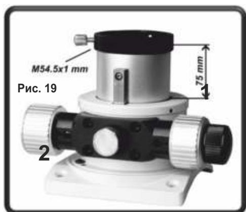
Максимальное расстояние выдвижения трубы фокусера из базы – 75 мм (Рис. 19.1). В особых случаях использования телескопа может потребоваться задний фокус больше стандартного 50-миллиметрового. В таком случае можно заменить адаптер 2" на кольцо M54,5x1мм (Рис. 19.2) и использовать его как базу под определенные аксессуары.
